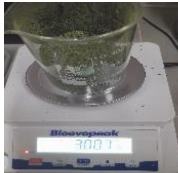
Pesado de la muestra HMSPA-1 Peso 30,07 g
