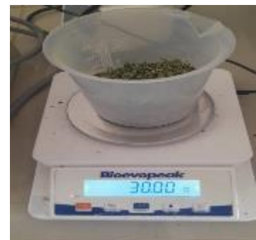
Pesado de la muestra HMSTO-3 Peso 30,00 g
