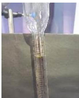
Medición del aceite obtenido del tratamiento HMSA-2; 2 mL
