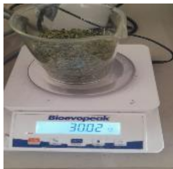
Pesado de la muestra HMSTO-2 Peso 30,02 g
