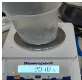
Peso de la muestra HMST-1 Peso: 30,10 g
