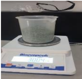
Pesado de la muestra HMSP-1 Peso 30,04 g
