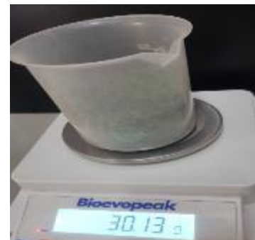
Pesado de la muestra HMSP-2 Peso 30,13 g
