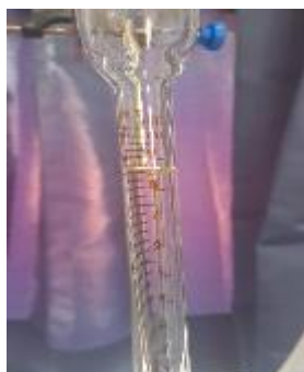
Medición del aceite obtenido del tratamiento HMSA-1; 0,2 mL
