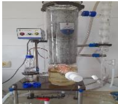
EXTRACTOR DE ACEITES ESENCIALES por Arrastre de Vapor
