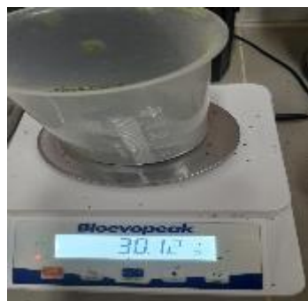
Pesado de la muestra HMSPA-3 Peso 30,12 g
