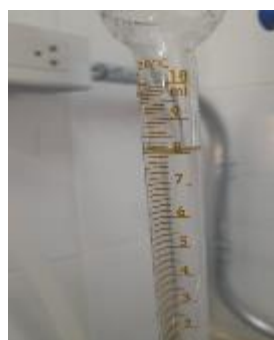
Medición del aceite obtenido del tratamiento HMSA-3; 0,2 mL
